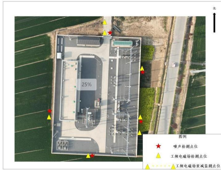
图 1 变电站检测点位示意图
