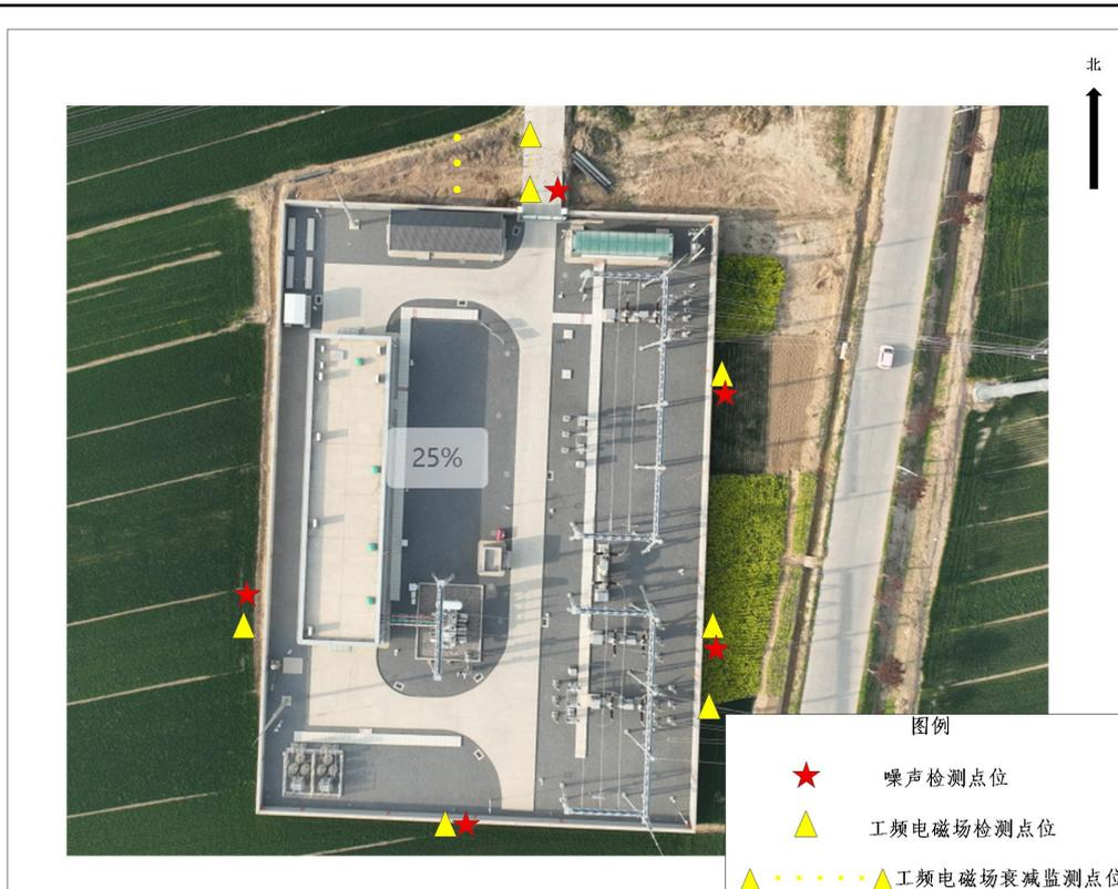
图 3-2 变电站监测点位示意图
