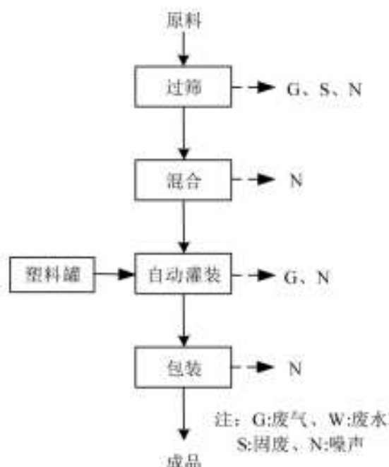
图 4 蛋白粉工艺及产污环节流程图
