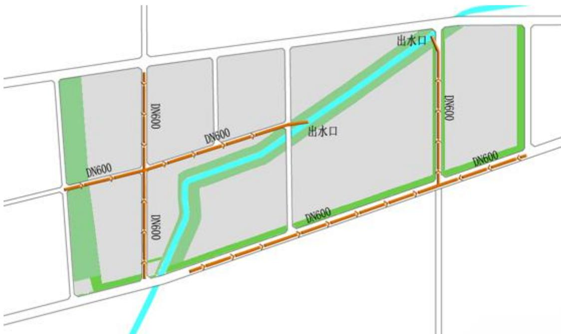
图10 北区雨水工程规划图
