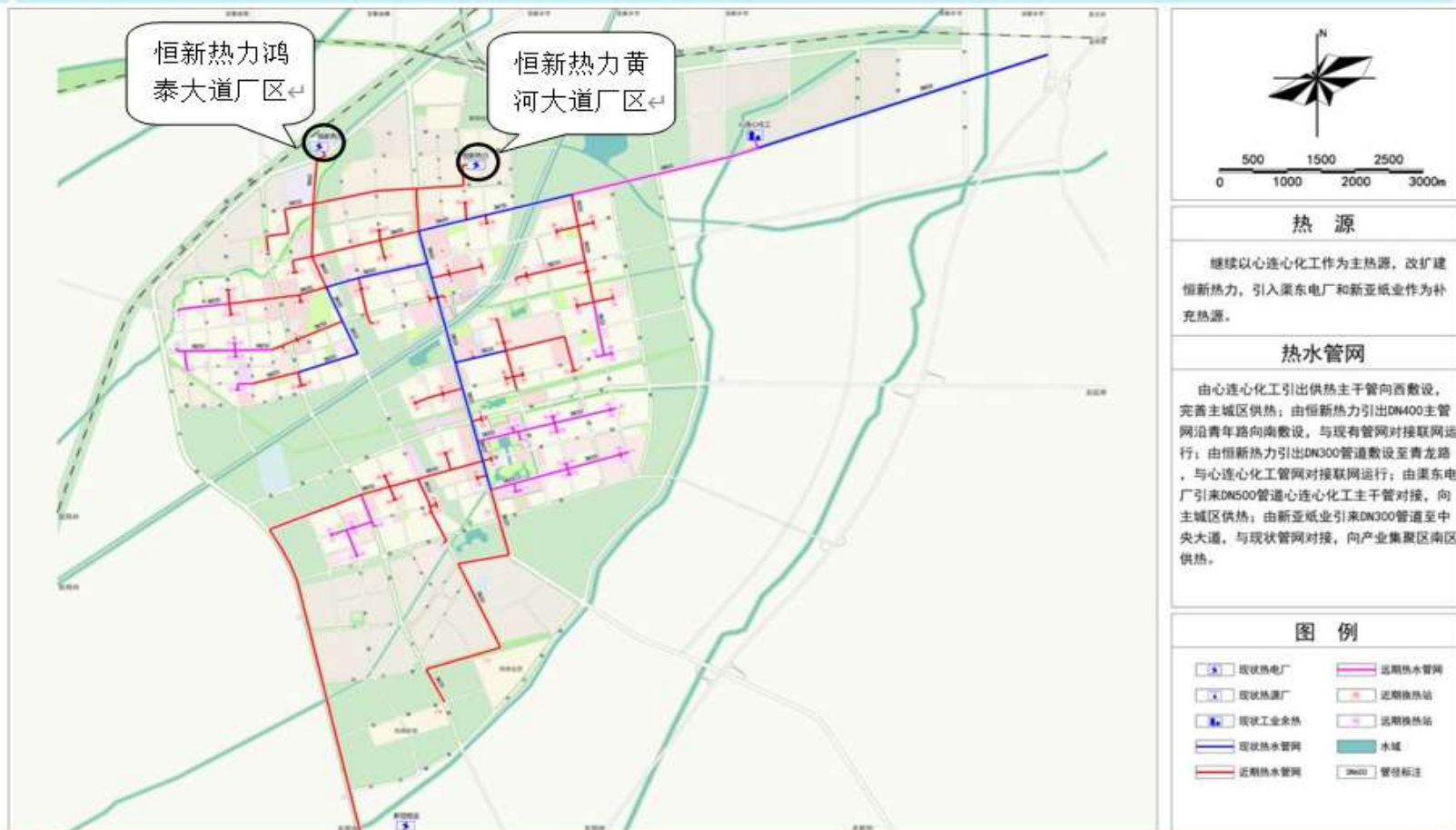
附图 5 新乡县热水管网规划图
